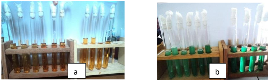
Gambar 1. Pemeriksaan sampel air dengan menggunakan uji pendugaan dengan menggunakan (a) media Laktosa Broth dan (b) Media BGLB yang digunakan dalam uji Penegasan 10 ml, 1,0 ml dan 0,1 ml
